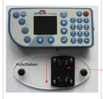
8) Setzen Sie den Timeboy auf die Richter-Halterung auf und rasten Sie mit einem leichten Druck gegen die Wand und nach unten das Gerät in der Halterung ein.
