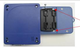
Achten Sie bitte darauf, dass Sie die Halterung wie auf dem Bild zwischen diesen beiden Schrauben fixieren.
