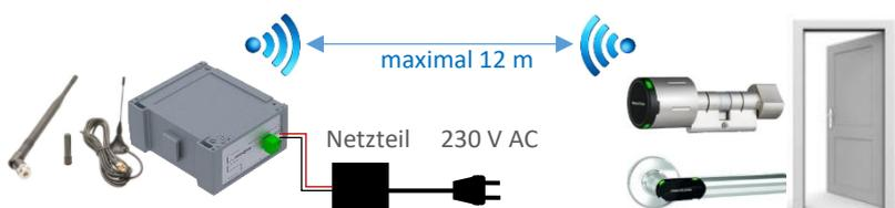
Platzieren Sie den KYO Inloc in unmittelbarer Nähe des geplanten Installationspunktes des Funkmoduls. Verbinden Sie den KYO Inloc mit der Spannungsversorgung. Warten Sie bitte ab bis der KYO Inloc vollständig hochgefahren ist. Nehmen Sie danach, je nach Verwendung, den Türdrücker oder Schließzylinder und halten Sie ihn vor die Tür an der die Komponente später eingebaut werden soll.
