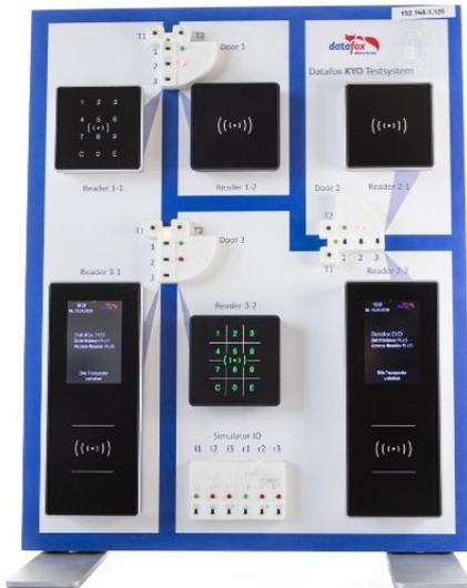
Das Datafox KYO Testsystem dient dazu, dem Entwickler bei der Einbindung der Datafox Zutrittskontrolle eine flexible Testumgebung zur Verfügung zu stellen.
