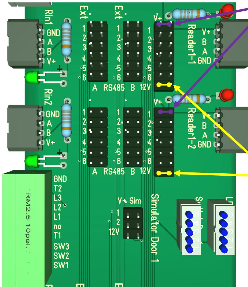
Jumper für die Spannungsversorgung.
