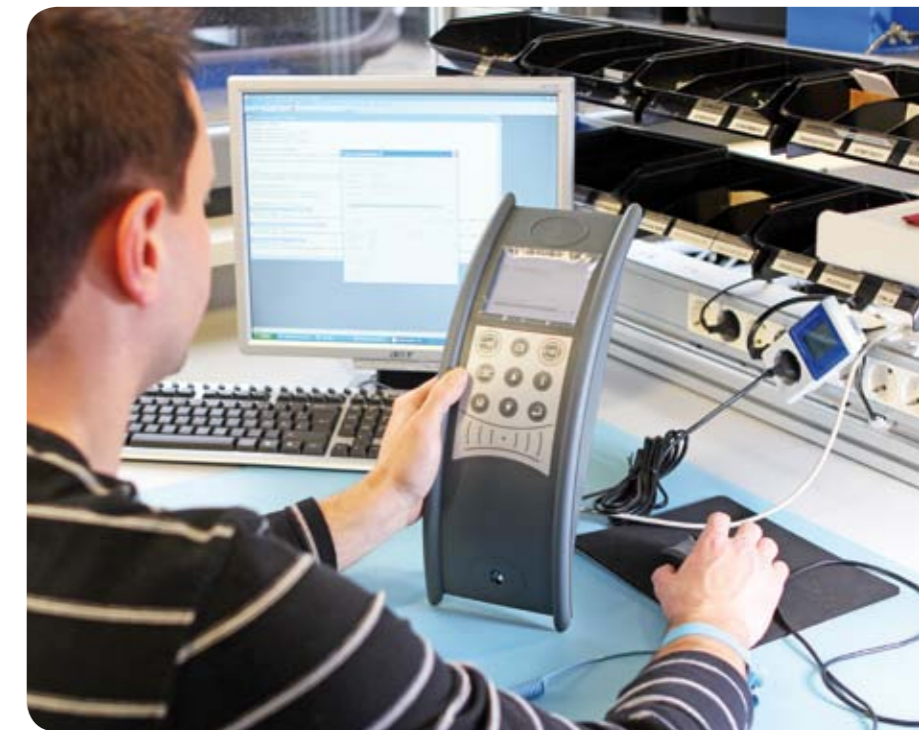
Parametrierung eines PZE-MasterIV mit Hilfe des Software-Tools Datafox Studio.
