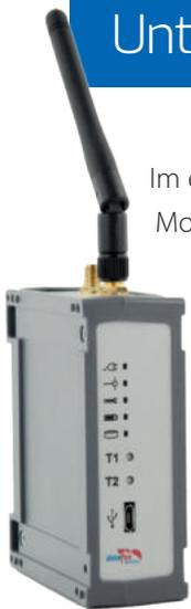
Im ersten Quartal 2021 wurde ein neues WLAN-Modul als Geräte-Option für die Datafox Devices aufgenommen. Mit dem neuen Upgrade kann nun zusätzlich zu der 2.4 GHz- auch die 5 GHz-Frequenz genutzt werden. Gleichzeitig wurde die Leistungsfähigkeit und Stabilität deutlich verbessert. Das neue Modul unterstützt zukünftig auch den WPA2 Enterprise Standard. Die neue Version ist so kompatibel, dass sie ohne zu-
